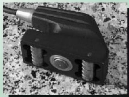
Com a simples instalação de uma chapa de aço, na largura total da saída do bobinador, o operador poderá efetuar medições em qualquer ponto do filme em movimento. Com o uso da função MEDIA é possível também determinar a espessura média de toda a largura do filme, permitindo uma produção mais eficaz.
