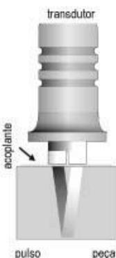
O **SME-P Plastic** envia um pulso de ultrassom por dentro da peça. Este pulso irá refletir quando houver uma descontinuidade na parede interna da peça, retornando ao transdutor. Este tempo de ida e volta do som, multiplicado pela velocidade determina a espessura da peça.
